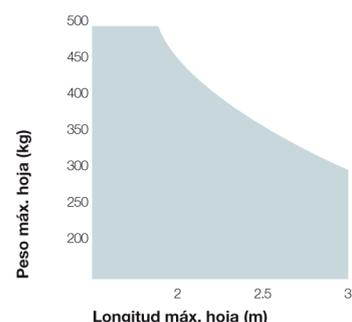
La forma, la altura de la puerta y la presencia de viento fuerte pueden disminuir notablemente los valores indicados en el gráfico. Para las zonas con viento fuerte, son preferibles los modelos 230 Vac.
