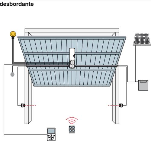
1. Ten 2. Transmisor 3. Fotocélulas 4. Luz intermitente 5. Selector de llave o digital 6. Panel solar SYP\* 7. Caja de la batería PSY24\* 8. Pantalla multifunción O-View\*.
